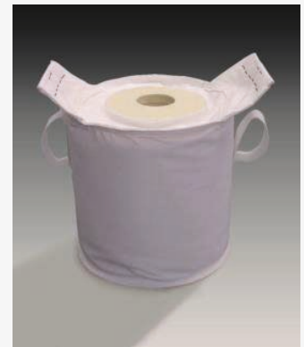
Kombinierte Mikrofilter und Trocknungspatrone CTFP 1000 wärmebehandelt Schmutzaufnahme: 1.100 g Feuchtigkeit: 1.300 ml Filterfeinheit 3 µm absolut inkl. Set Dichtungen
